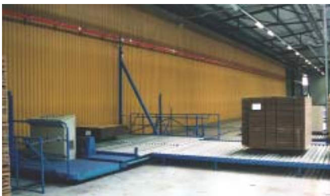
Railkoker type RN7 voor de voeding en besturing van een traversewagen in een kartonnagefabriek.
